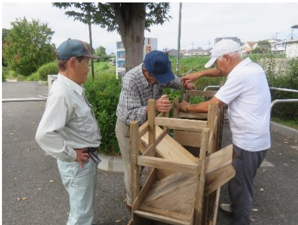
唐箕の補修作業 石などを取り除く
